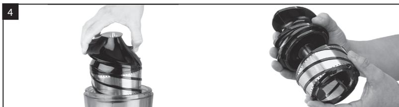
Wyjąć wałek ślimakowy z bębna i go rozebrać. Przekręcić górną część wałka ślimakowego przeciwnie do kierunku ruchu wskazówek zegara, aby oddzielić ją od jego dolnej części.
