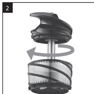
Zamocować wałek ślimakowy obracając jego górną część zgodnie z kierunkiem ruchu wskazówek zegara do momentu usłyszenia „kliknięcia”.
