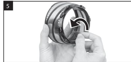
Das Gummipad von der Innenseite der Schnecke entfernen.
