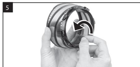
Wyjąć gumową podkładkę znajdującą się po wewnętrznej stronie wałka ślimakowego.
